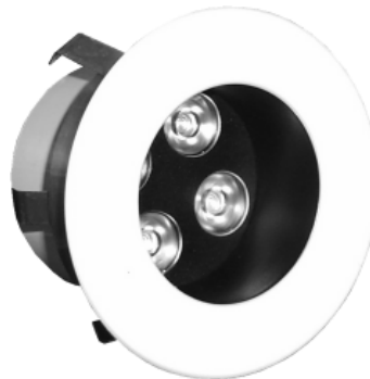
Diamètre d'encastrement / Diameter of cut out: 67mm Diamètre de la collerette / Diameter of flange: 78mm Saillie de la collerette / Thickness of flange: 2mm Longueur spot / Spotlight length: 60mm
